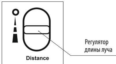
В режиме Virtual Wall (Виртуальная стена) установите длину луча с помощью регулятора: на 1м, 2м, более 2,4м. Устройство создает вокруг себя защитный круг, не позволяющий роботу подойти к нему слишком близко.
