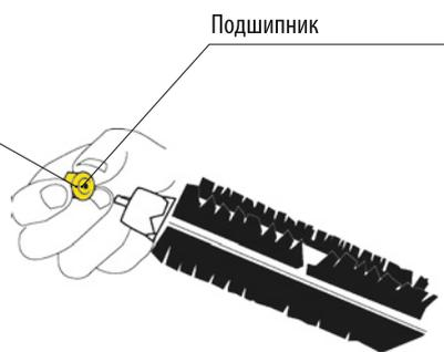
С помощью специального приспособления — зубчатого кольца (входит в комплект поставки) — снимите с ворсяной щетки волосы, нити и другой мусор
