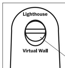
Переключатель режимов позволяет выбрать режим Ограничителя – Виртуальной стены (Virtual Wall®) или режим Координатора – Маяка (Lighthouse®).
