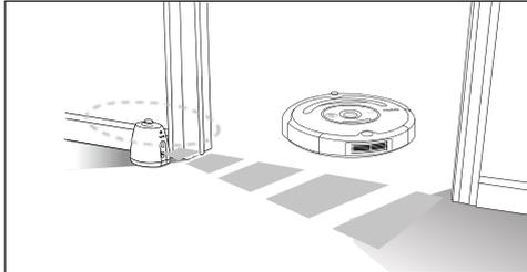
В режиме Virtual Wall разместите Координатор с внешней стороны дверного проема комнаты, которую Вы хотите заблокировать. Устройство с помощью инфракрасного луча создает невидимую границу, которую робот не может пересечь.
