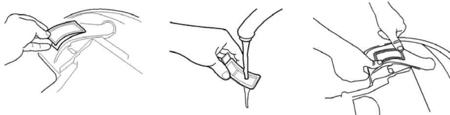
**⚠️ внимание:** Внутри робота Scooba есть электроника, которую можно испортить брызгами воды или другой жидкости. Верхнюю и нижнюю части Scooba протирайте только влажной тряпкой. Не проливайте и не брызгайте воду на Scooba. Воду можно заливать только в специальные баки робота Scooba.
