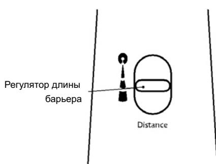
В режиме виртуальной стены шлюзы можно отрегулировать в трёх разных позициях: чтобы длина луча была около 1-ого метра, около 2-ух метров и более 2,4 метра. Устройство также создаёт вокруг себя защитный круг, который не позволяет роботу подойти слишком близко, а конусообразный луч не позволяет роботу попасть на территорию, которая не нуждается в его уборке.
