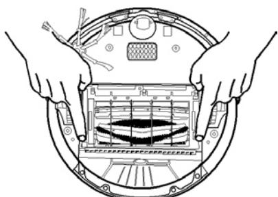
**Б.** Снимите колпачки и воспользуйтесь ножницами, чтобы обрезать все волосы, замотавшиеся вокруг щётки.
