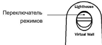
Переключатель режимов позволяет выбирать режим виртуальной стены (Virtual Wall) или режим виртуальных шлюзов (Lighthouse).
