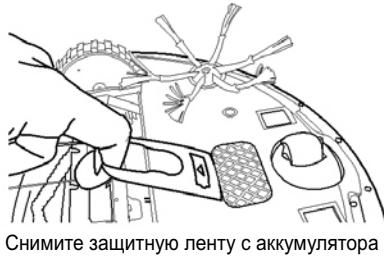
Снимите защитную ленту с аккумулятора
